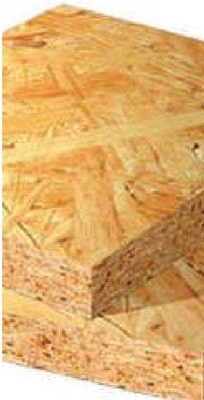
**Aglomerado de partículas OSB\*:** Fabricado a partir de partículas de madera de diferentes tamaños que se presnan y unen con resinas adhesivas.
