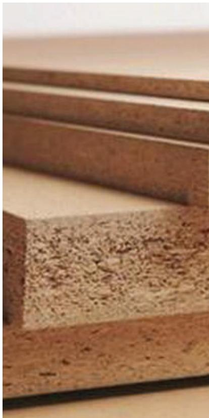
**MDF: (Tablero de Fibra de densidad media):** Fabricado a partir de fibras de madera finamente molidas que se mezclan con resinas y se presnan para formar paneles de densidad uniforme.
